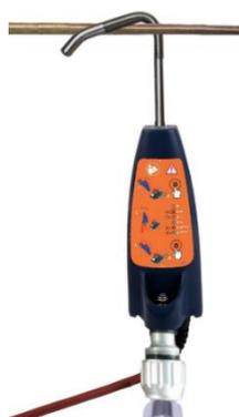
3. Attendre au minimum 3 secondes avant de lire les informations données par l'appareil suivant le tableau des résultats de la VAT ci-après
