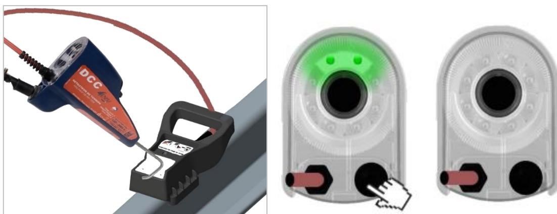
**⚠ ATTENTION : Le test de vérification d'absence de tension est validé seulement et seulement si, l'outil s'éteint. Si ce n'est pas le cas, réaliser de nouveau la procédure d'autocontrôle et d'utilisation.**
