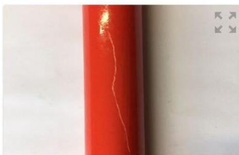
← **Contrôle du tube isolant rouge**
