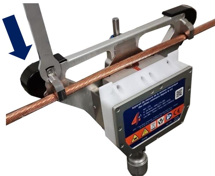
2. Exercer une rotation pour tourner le crochet et dégager l'appareil du fil ou câble.
