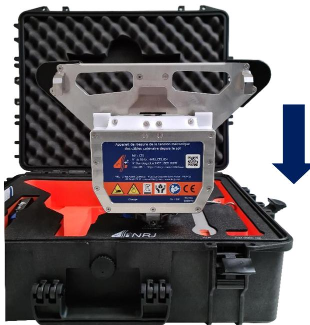
B. Mettre le calibre de contrôle sur l'outil de mesure. Positionner le calibre sur les appuis et effectuer une rotation pour verrouiller le calibre.
